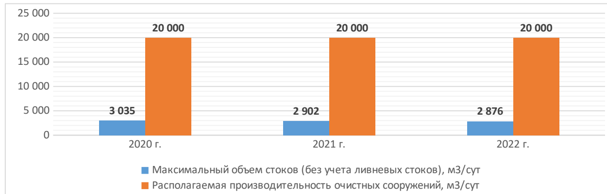
Рисунок 2.1.1 - Динамика резервов производительности очистных сооружений г. Карабаново
